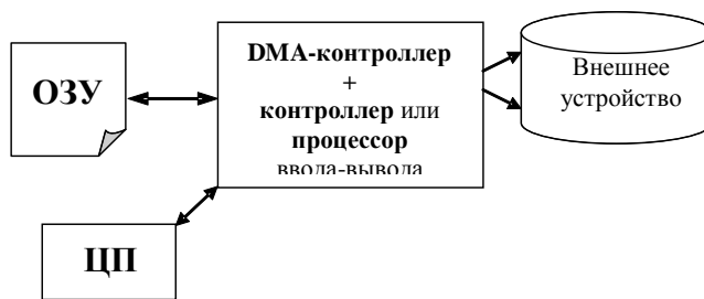
Рис. 41. Использование контроллера прямого доступа к памяти (DMA) или процессора (канала) ввода-вывода при обмене.
