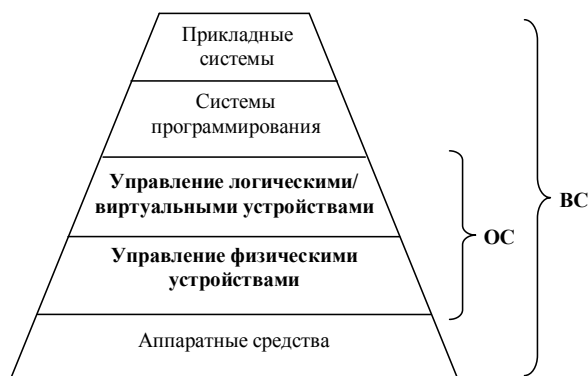
Рис. 4. Структура вычислительной системы.
