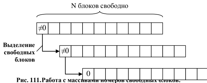
Рис. 111. Работа с массивами номеров свободных блоков.
