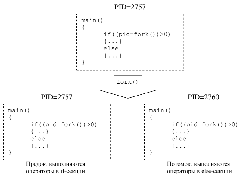
Рис. 76. Пример использования системного вызова fork() .
