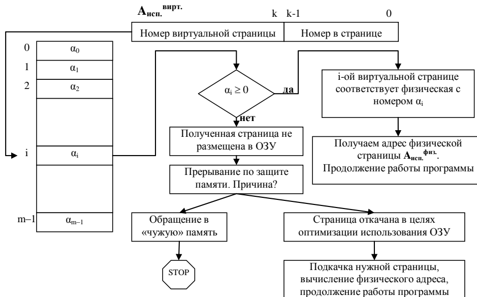
Рис. 52. Страничная организация памяти. Схема преобразования адресов.
