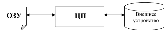
Рис. 39. Непосредственное управление центральным процессором внешнего устройства.
