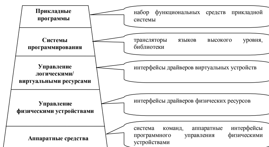
Рис. 19. Структура организации вычислительной системы.
